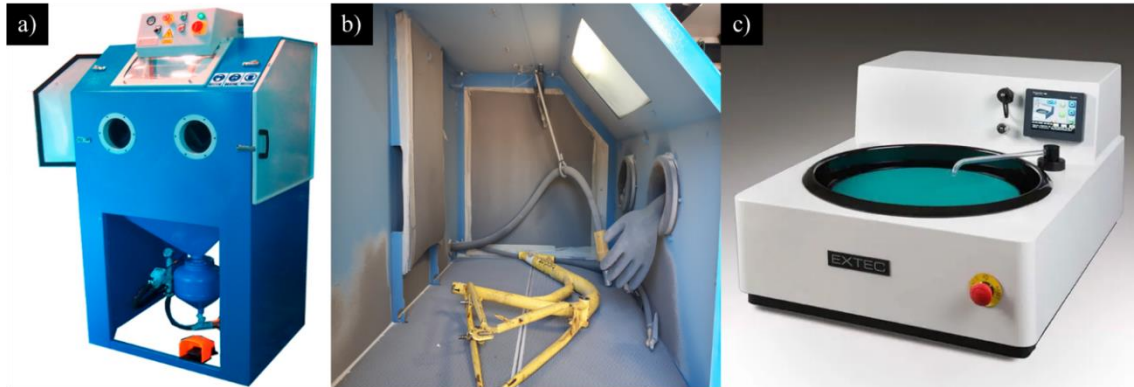
Figura 2.8. a) Máquina de pulido por chorro de arena (chorreadora de sistema seco, modelo Mega, fabricado por Abrasivos y Maquinaria S.A). b) Detalle del interior de la chorreadora. c) Máquina pulidora automática de la marca Labopool, semejante a la utilizada en esta Tesis Doctoral.
