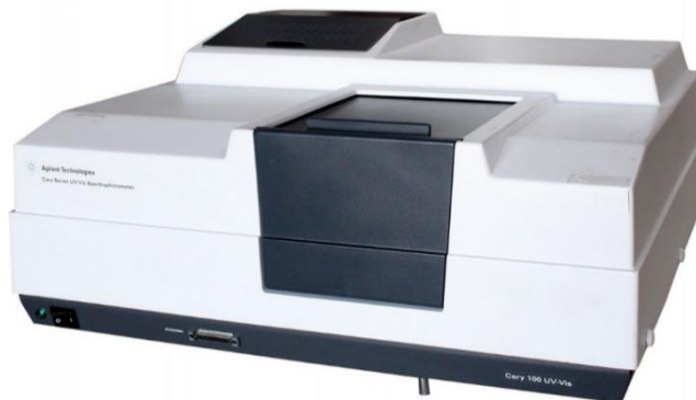
Figura 2.11. Imagen de un espectrofotómetro UV-Visible Cary 100.
