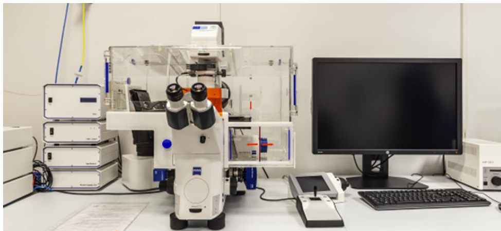
Figura 2.10. Imagen del microscopio confocal ZEISS LSM 7 DUO utilizado en este trabajo.
