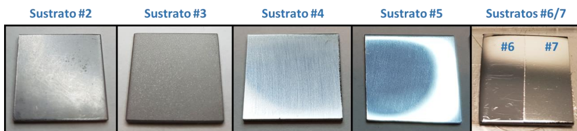
Figura 4.1. Serie de fotografías tomadas a los sustratos de acero inoxidable que se han utilizado. Ver Tabla 4.1 para detalles del tratamiento realizado a cada uno.
