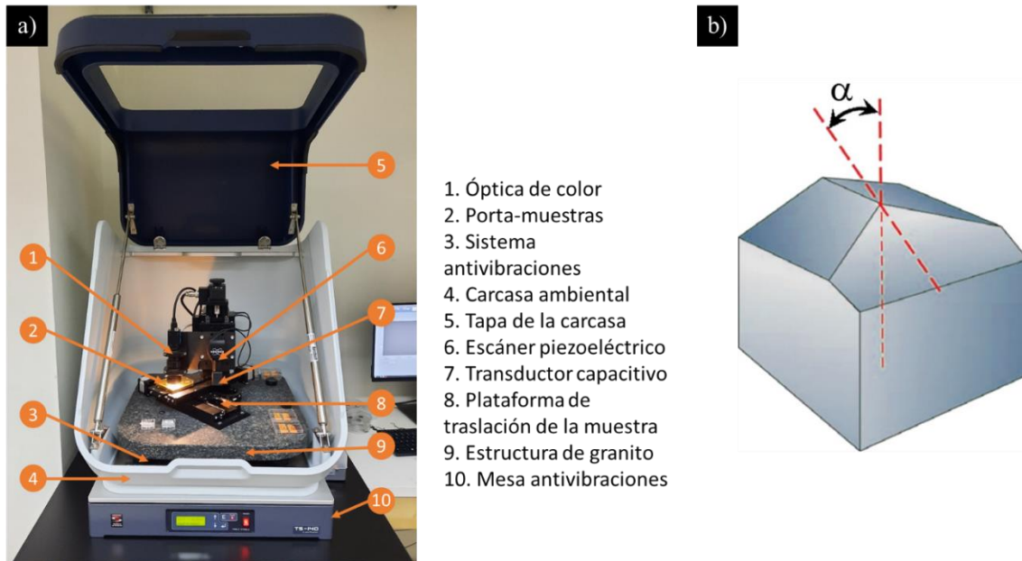
Figura 2.15. a) Nanoindentador utilizado para las medidas de SPM de la Universidad Complutense de Madrid, modelo TS77 Select (Bruker-Hysitron). b) Geometría Berkovich, con un semiángulo interior de \alpha = 65.03^\circ .
