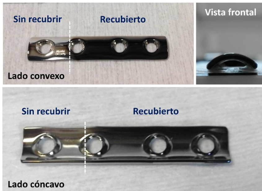
Figura 5.4. Diferentes vistas del implante DePuy Synthes recubierto en el reactor-I. Se utilizó una máscara que protegía aproximadamente una cuarta parte de la placa para tener una zona sin recubrimiento que permitiera la comparación al realizar análisis in vitro .
